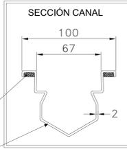
Acero inoxidable Aisi 304 (Aisi 316 a pedido) - Espesor chapa 2 mm
