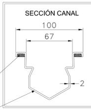
Acero inoxidable Aisi 304 (Aisi 316 a pedido) - Espesor chapa 2 mm
