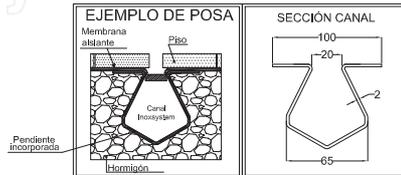
Acero inoxidable Aisi 304 (a pedido Aisi 316) - Espesor constructivo 2 mm
