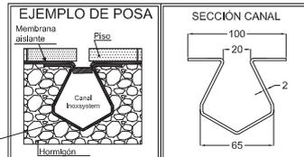
Acero inoxidable Aisi 304 (a pedido Aisi 316) - Espesor constructivo 2 mm
