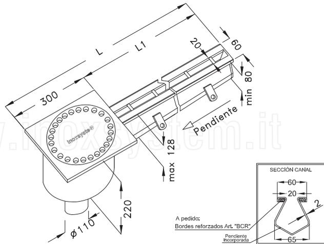
Acero inoxidable Aisi 304 (a pedido Aisi 316) - Espesor constructivo 2 mm
