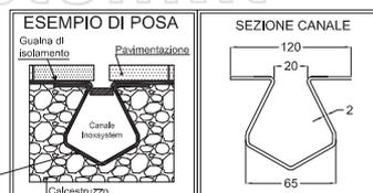
Acciaio Aisi 304 (a richiesta Aisi 316) - Spessore costruttivo 2 mm
