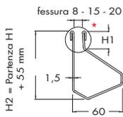
\* Bordi verticali a sezione conica studiati per evitare l'ostruzione della fessura
