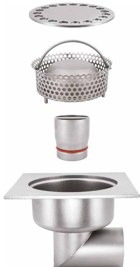
**Consigli:** - La tipologia di sifone con tubo estraibile è studiata per permettere, mediante la semplice rimozione dello stesso, il completo drenaggio dell'acqua presente all'interno del chiusino e dunque una totale pulizia del pozzetto. Ricordiamo che, una volta completata la pulizia, si raccomanda di riempire l'interno del pozzetto con dell'acqua nuova per rimettere in funzione il sifone anti-odore.
