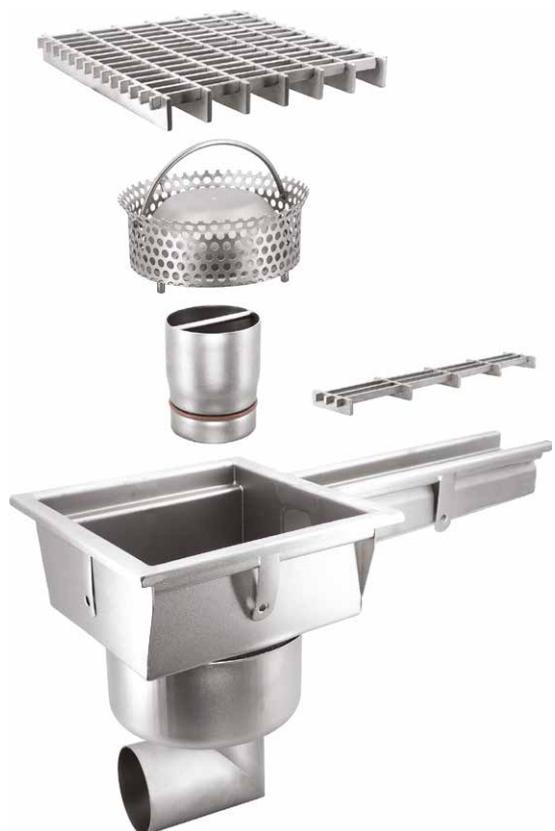
**Consigli:** - La tipologia di sifone con tubo estraibile è studiata per permettere, mediante la semplice rimozione dello stesso, il completo drenaggio dell'acqua presente all'interno del chiusino e dunque una totale pulizia del pozzetto. Ricordiamo che, una volta completata la pulizia, si raccomanda di riempire l'interno del pozzetto con dell'acqua nuova per rimettere in funzione il sifone anti-odore.
