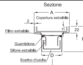
Inoxsystem® IDrain 3268 - Piletta con copertura pavimentabile a fessura perimetrale Forma quadra - Senza bordi - scarico verticale - sifone e filtro estraibili
